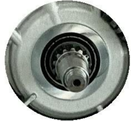
FOTO DETALHADA DA POSIÇÃO DO SELO DE ÓLEO DO VIRABREQUIM
